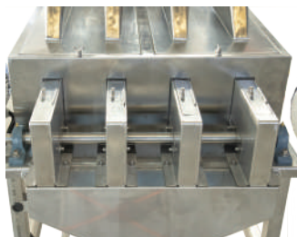
Blower bar made by SUS 304 Barre de soufflage fabriquée en acier inoxydable SUS 304
