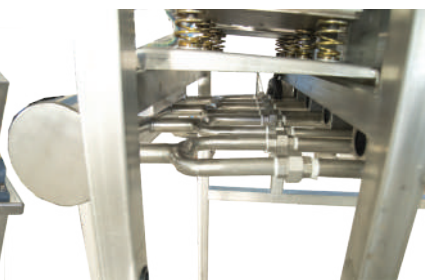
Pipline made by SUS 304 Tuyauterie fabriquée en acier inoxydable SUS 304
